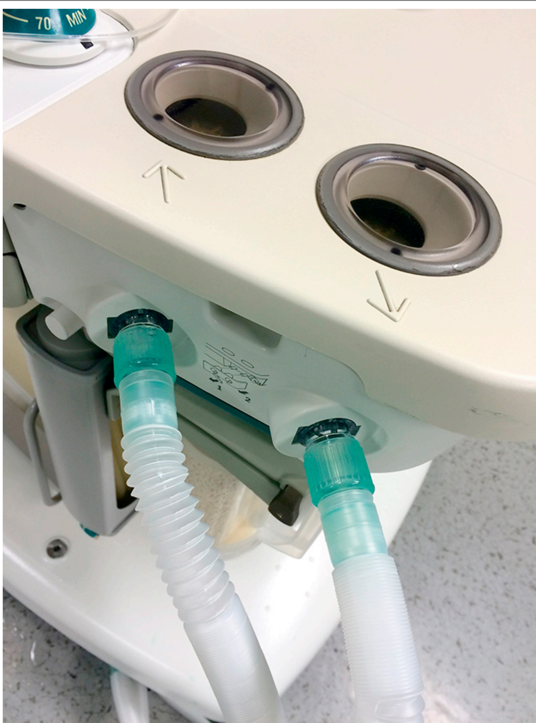
Patientennahes Ende des Beatmungsschlauches Oxylog® 3000 mit Patientenventil, Flowsenor und Winkelstück (hier als Einmalartikel „disposable“)
